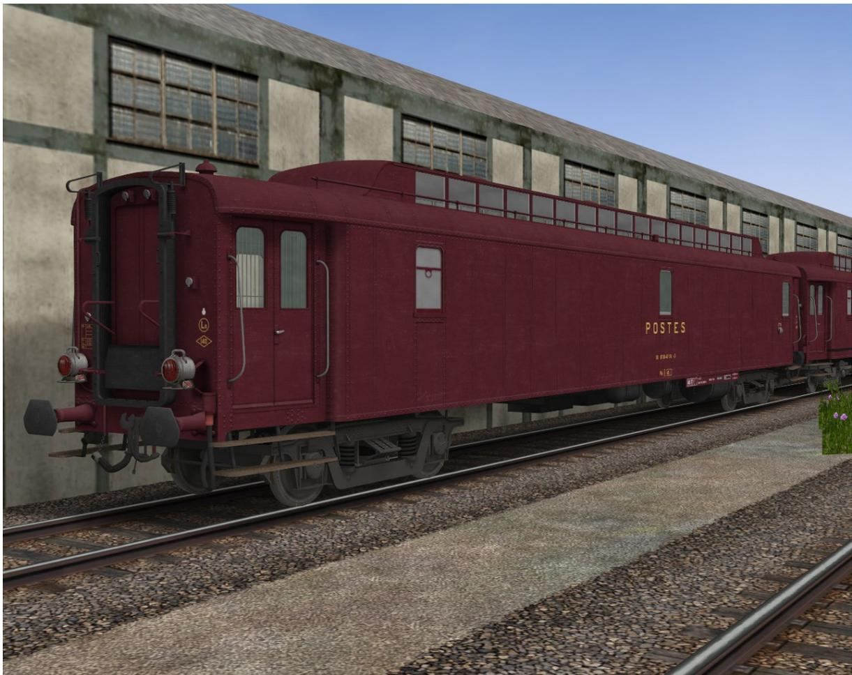
Image 1: Ambulant OCEM de 20 mètres non modernisé, en livrée brun PTT et monté sur bogies Y2
