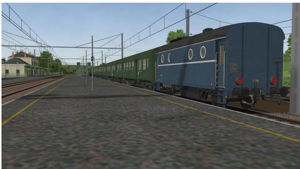
Image 3: Fourgon-chaudière au sein d'une rame de voitures « Romilly »
